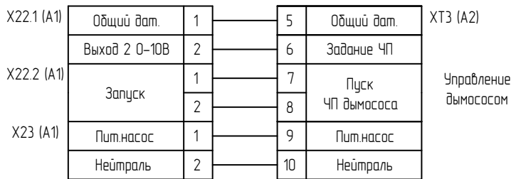
Подключение управления шибером для варианта МГ-ГБЛ-Н с частотным преобразователем (ЧП) двигателя дымососа
