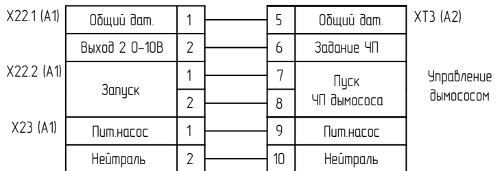
Подключение управления шибером для варианта МГ-ГБЛ-Н с частотным преобразователем (ЧП) двигателя дымоcоса
