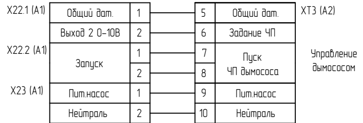
Подключение управления шиберам для варианта МГ-ГБЛ-Н с частотным преобразователем (ЧП) двигателя дымососа
