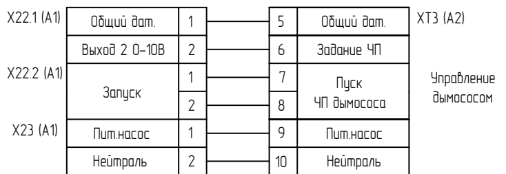
Подключение управления шибером для варианта МГ-ГБЛ-Н с частотным преобразователем (ЧП) двигателя дымососа
