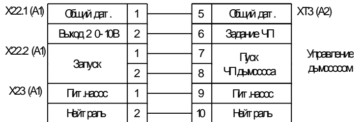
Подключение управления шибером для варианта М-ГБТ-Н с частотным преобразователем (ЧП) двигателя дымососа
