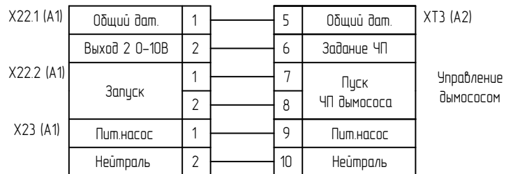
Подключение управления шибером для варианта МГ-ГБЛ-Н с частотным преобразователем (ЧП) двигателя дымососа
